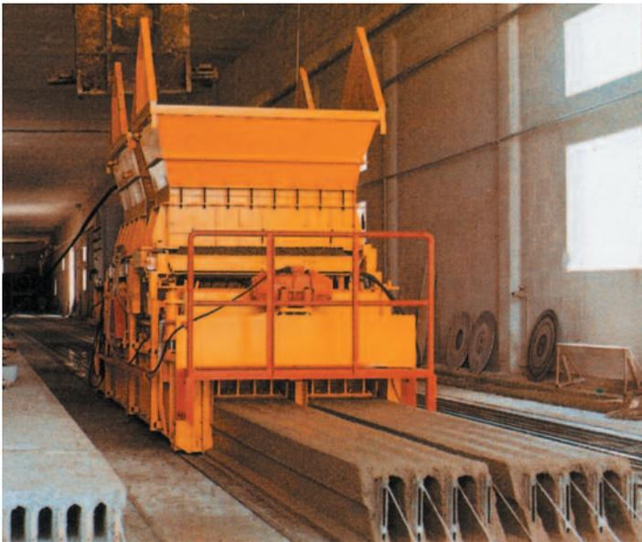
*Fig. 2.4 Vertido continuado del hormigón*
