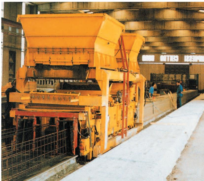
Fig. 2.1 Máquina moldeadora (procedimiento “slipform”)
