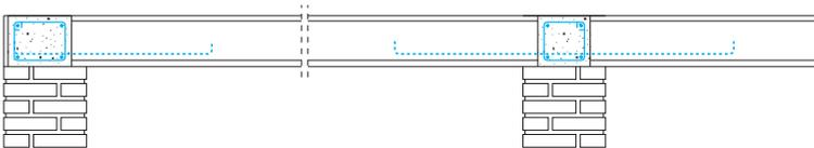
Fig. 4.6 *Losa hueca simplemente apoyada.*
