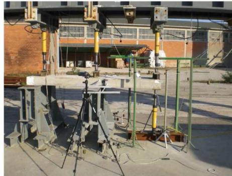
Foto dell'allestimento di una prova a flessione ciclica.
